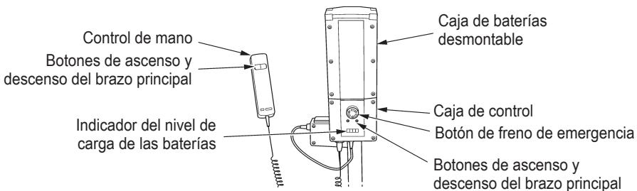
Cuando haya que cargar la unidad de alimentación, habrá que extraerla del elevador y colocarla en el cargador de sobremesa. El nivel de carga de la batería se visualiza en el indicador en el cuadro de control.
