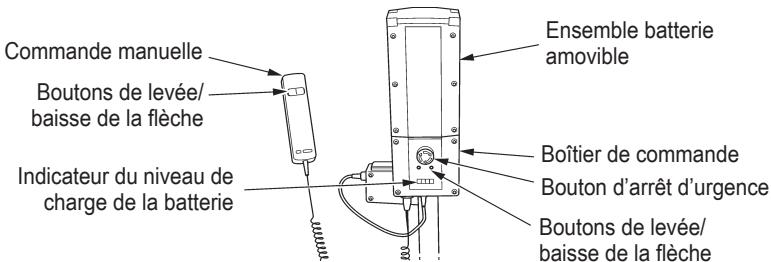
Lorsque le bloc d'alimentation doit être rechargé, retirez-le du lève-personne et branchez-le sur le chargeur autonome. Le niveau de charge de la batterie est affiché par l'indicateur sur le boîtier de commande.
