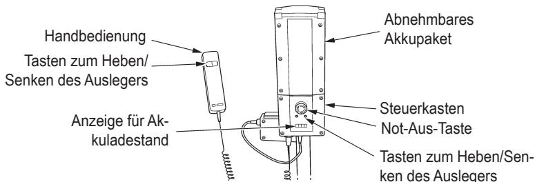
Wenn die Akkueinheit aufgeladen werden muss, wird sie vom Lifter entfernt und an eine externe Ladeeinheit angeschlossen. Der Akkuladestand wird an der Anzeige an der Handbedienung angezeigt.
