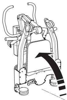
**HINWEIS:** Wenn Sie den Mast und den Ausleger ganz vom Fahrgestell abnehmen wollen, öffnen Sie den Verriegelungshebel für den Mast ganz (nehmen Sie den Verriegelungsstift vom Mast ab) und heben Sie den Mast und den Ausleger ganz vom Fahrgestell ab. Achten Sie darauf, dass der Verriegelungshebel für den Mast und der Rastbolzen nicht verloren gehen.
