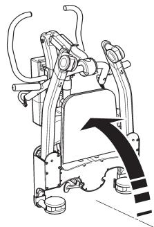
**NOTA:** Si desea separar completamente el mástil y el brazo principal de la base y las patas, abra la palanca de fijación del mástil al máximo (retire las piezas de la clavija del mástil) y separe mástil y brazo principal de la base. Procure no perder la palanca de fijación del mástil y el husillo de ubicación.
