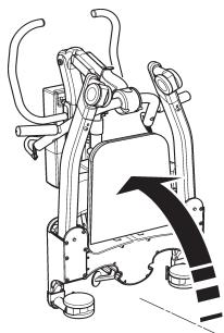
**REMARQUE :** Vous pouvez complètement démonter le mât et la flèche et les désolidariser de la base et des pieds. Pour cela, dévissez complètement le levier de verrouillage du mât (retirez la goupille du mât) et levez le mât et la flèche pour les libérer de la base. Prenez soin de ne pas égarer le levier de verrouillage et la tige.
