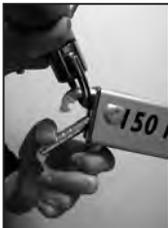
Einfache Öffnung des Karabinerhakens durch Drücken des Schnappers mit einem Finger und Einhängen des Spreizbügels.
