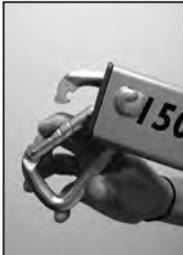
Korrekt am Ausleger montierter Karabinerhaken, einsatzbereit.
