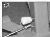
Sicherungsstift **nicht korrekt** eingesteckt.
