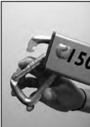
Mosquetón ubicado correctamente en el brazo de elevación y listo para su utilización.
