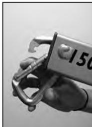
Karbinhake korrekt monterad på bommen och klar för montering av lyftbygel.
