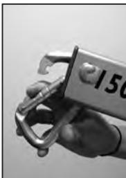
Positionner correctement le mousqueton sur la flèche, prêt pour l'utilisation.
