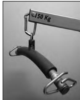
Barra de fixação de cesta correctamente colocada
