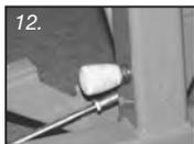
Perno di bloccaggio inserito non correttamente.
